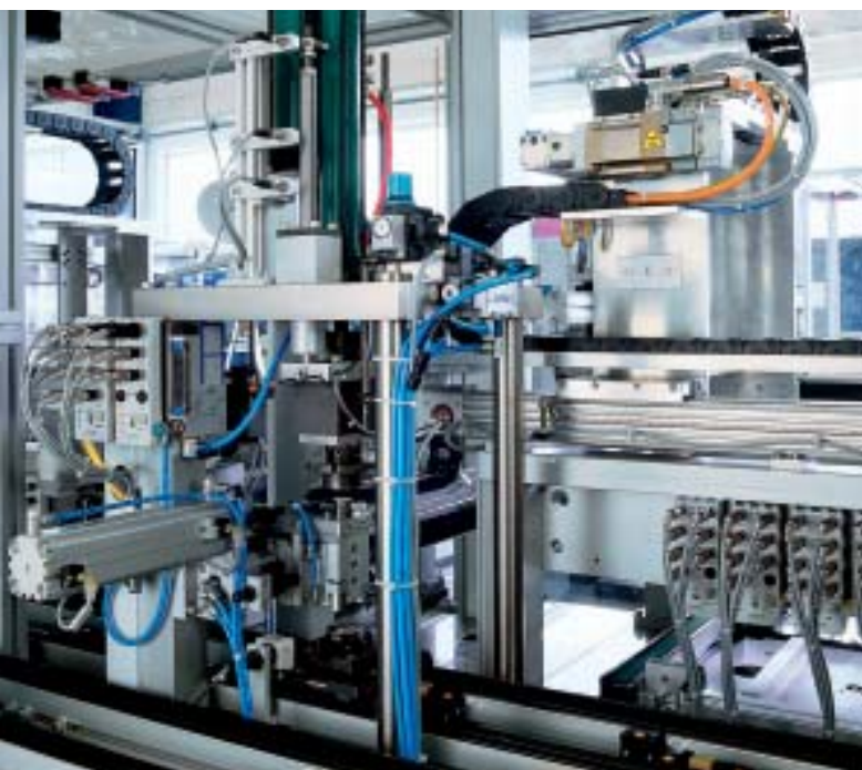
Einlegen und Verstemmen des Konus im Magnetspulen-Gehäuse
