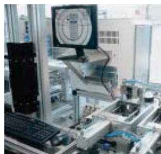
Station 5: Optische Kontrolle der Verstemmsegmente am Konus
